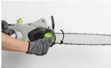
La cadena tendrá la tensión correcta si no hay comba en la parte inferior de la barra guía y la cadena está ajustada pero se puede girar a mano sin que se trabe.
